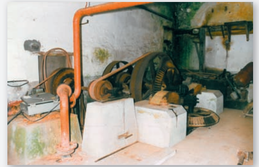
Les rouets transmettant le mouvement de la turbine (placée en-dessous).
