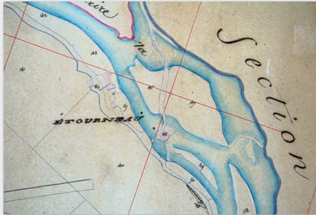
Cadastr. 1839. Remarquer le système complexe des trois chaussées-déversoirs ; et, à l'aval, la passerelle prolongée par la chaussée muletière.
