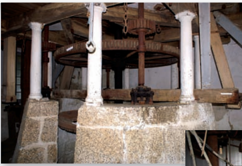
Le beffroi et les rouets d'entraînement des quatre meules tournantes.
